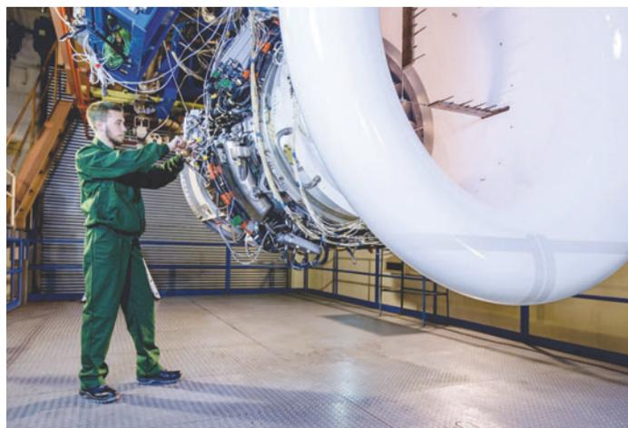
Первый опытный двигатель ПД-8 на испытательном стенде ОДК-Сатурн
