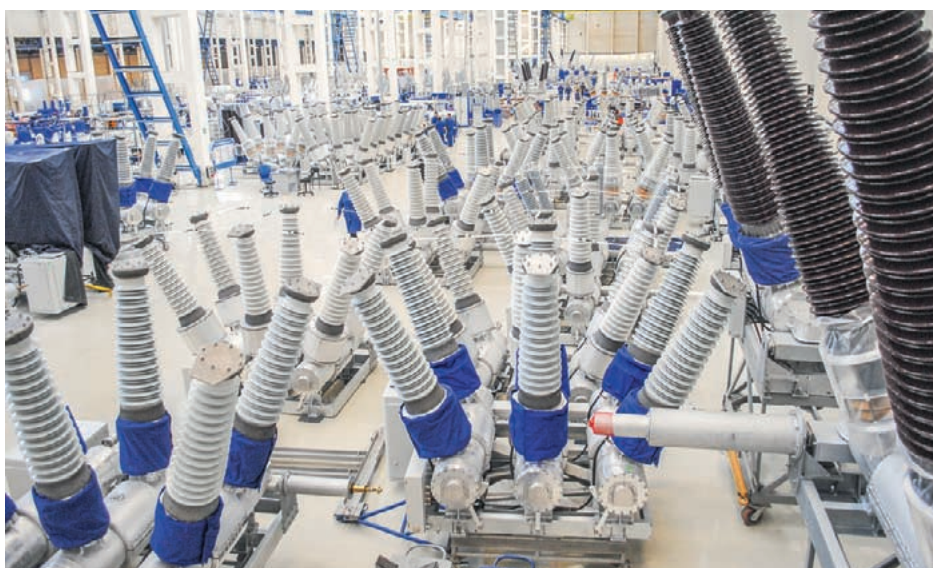
Производство высоковольтной аппаратуры
